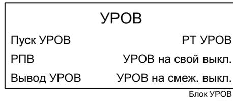
Рисунок 66 – Функциональный блок УРОВ
