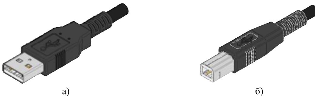
Разъемы USB: а) тип А; б) тип В
